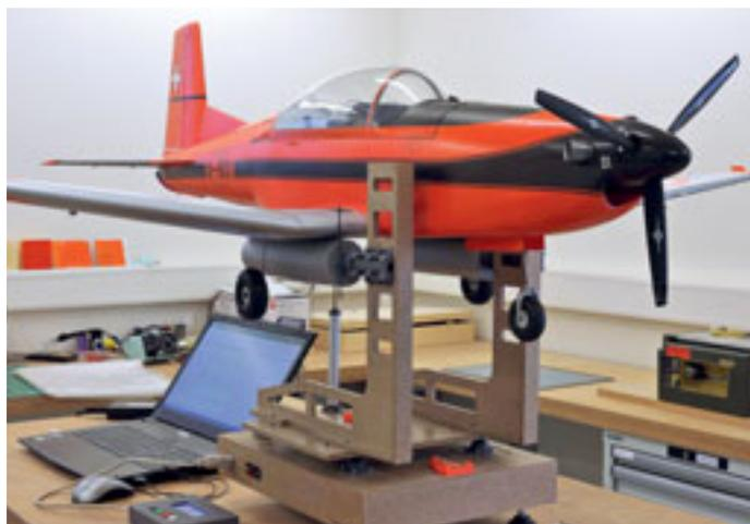
Abb. 11: Schwerpunktlage des PC-7 messen und notieren.
