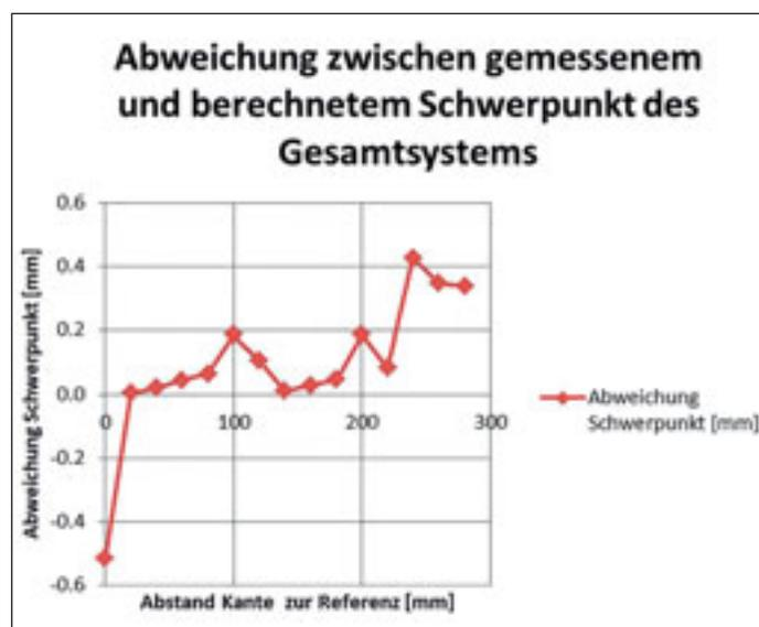
Abb. 10: Die Abweichung der gemessenen und der berechneten Schwerpunktlage beträgt  $\pm 0,5$  mm.
