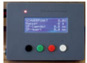
**Abb. 8: Anzeige des Gesamtgewichtes und der Schwerpunktlage.**
