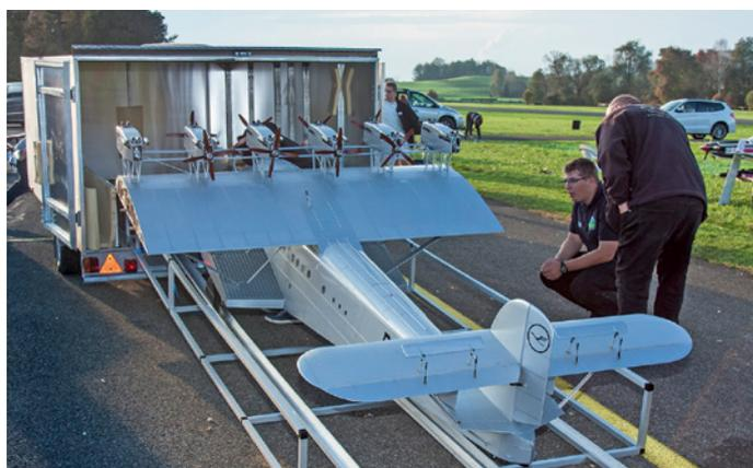
Der Anhänger ist zentimetergenau auf die Grösse der heimischen Garage abgestimmt. Um Zeit beim Auf- und Abbau zu sparen, verbleibt das präzise auf die Anhängerbreite abgestimmte Tragflächenmittelstück immer auf dem Rumpf. Die vier äusseren Propeller müssen allerdings aus Platzgründen für den Transport demontiert werden.
