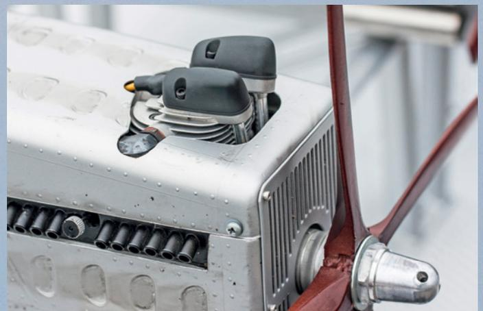
12 Auspuffrohre sind links auf der Motor­gondel angedeutet, jeder 4-Takt-Ein­zylinder-Motor mit 10 ccm treibt einen 4-Blatt-Holzpropeller an, der in Wirklichkeit aus zwei 2-Blatt-Propellern zusammengebaut worden ist.
