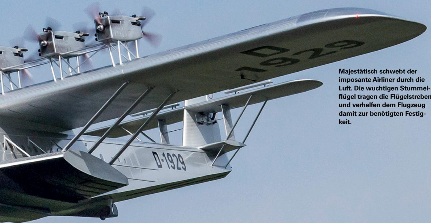
Majestätisch schwebt der imposante Airliner durch die Luft. Die wuchtigen Stummel­flügel tragen die Flügelstreben und verhelfen dem Flugzeug damit zur benötigten Festig­keit.
