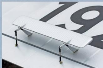
Hilfsflossen an den Rudern reduzieren den Steuerdruck. Denn die grossen Ruder wurden damals noch direkt aus dem Cockpit über Drahtseile angesteuert.
