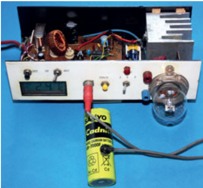
Selbstbau-Thermolader aus den 1990er-Jahren. Mit Conrad-Temperaturschaltmodul und Kfz-Biluxbirne als Stromstabilisator.
