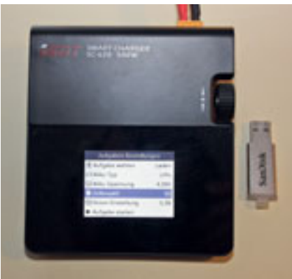
Aussen klein – innen ganz gross: der ISDT-Charger SC-620 mit immerhin 0,5 kW Ladeleistung; dazu mit geradezu vorbildlichem Bedienungskomfort.
