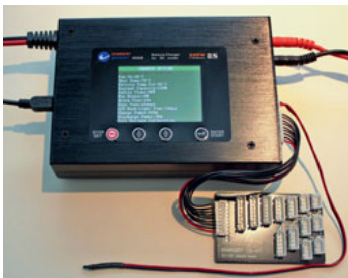
Chargery 5008B kann bis zu 8 LiPos «am Stück» mit 500W und max. 20 A laden. Ein vielseitiges Gerät für Zeitgenossen, die sich gerne mit Technik befassen.
