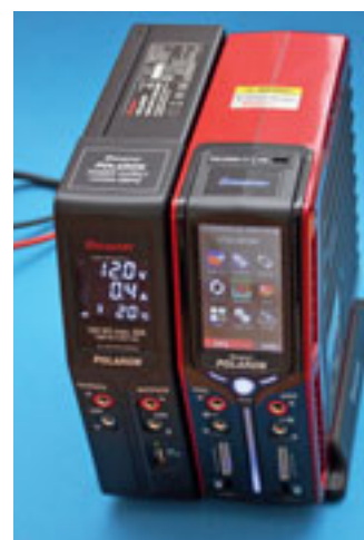
Kann denn Schönheit Sünde sein? POLARON-EX-Lader mit angekoppeltem Netzgerät. Ladbar sind 2x7s-LiPos, max. 25 A.
