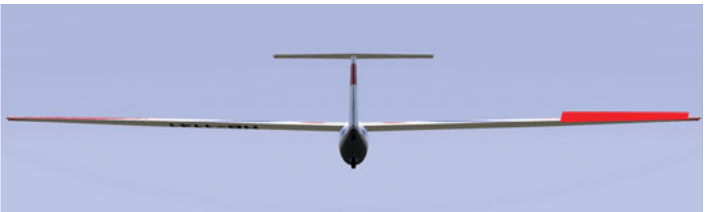
Das nennt sich «Split». Kein Ausschlag nach unten, bei raketenschnellen Hotlinern ist das mitunter nötig, bei der hier gezeigten B 4 aber garantiert nicht.
