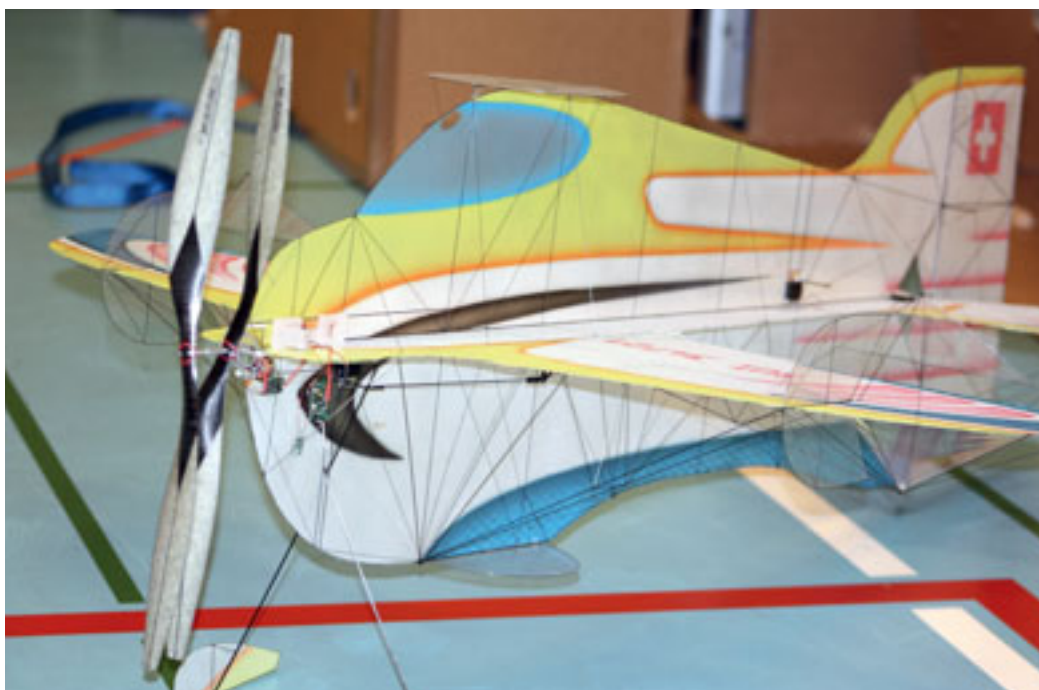
Merveille de technologie: 54 g, 89 cm, 2 hélices contrarotatives, moteur Glavak pour des vols acrobatiques lents à vitesse constante.
