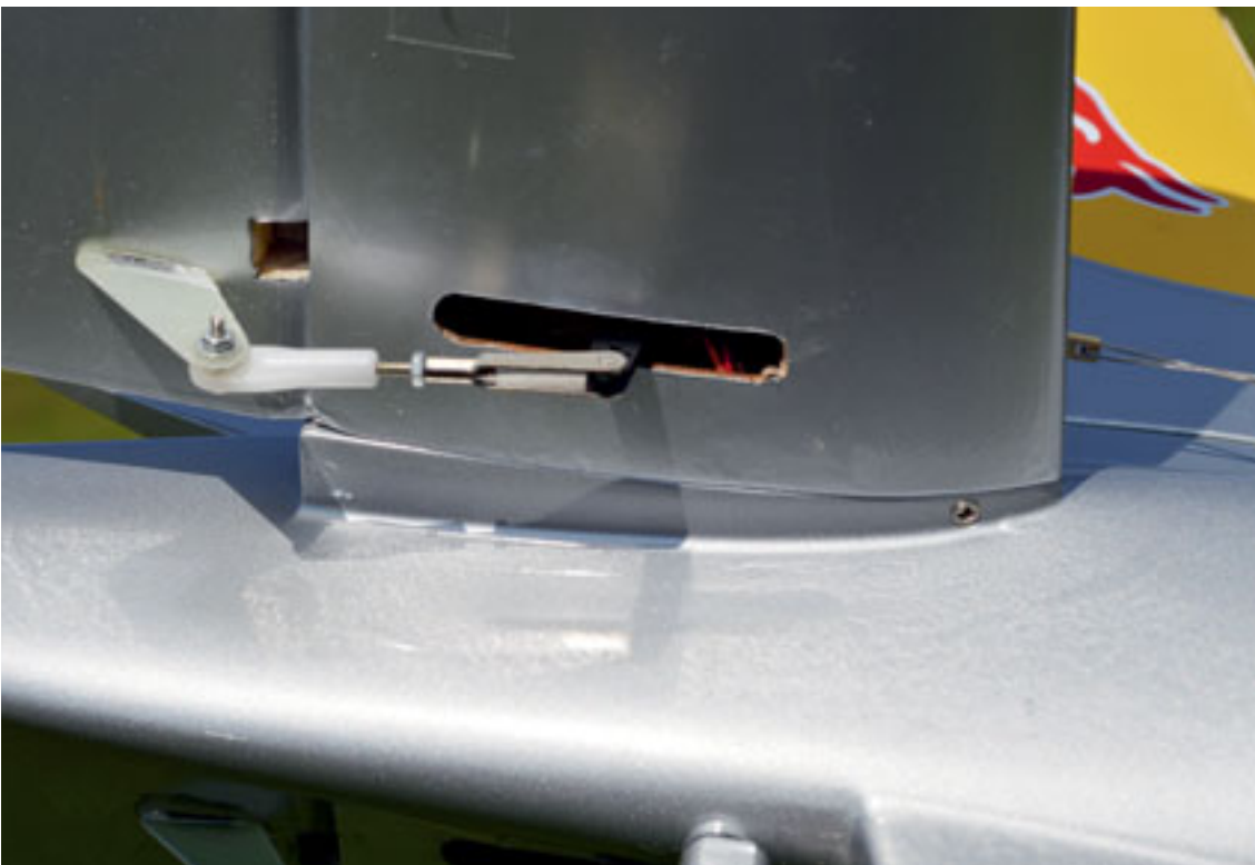
Seitenrudieranlenkung. Hier ist keine Differenzierung erwünscht. Der Servo-Abtriebshebel steht rechtwinklig zur Rumpflängsachse, Anlenkpunkt des Ruderhorns auf Höhe der Drehachse.
