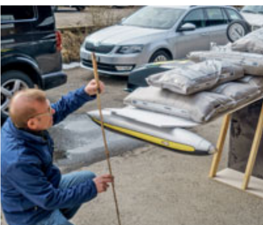
Durchbiegung des Flügels ca. 4 cm und gleich viel zurück. Flexion des ailes de 4 cm et autant en retour.
