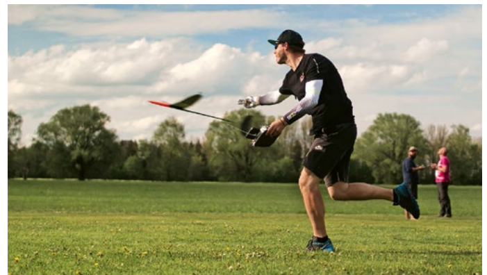
Sobald das Modell die Richtung erreicht, sollte es die maximale Geschwindigkeit haben und kann losgelassen werden. Durch die hohe Geschwindigkeit drehen Arm und Oberkörper weiter und es beginnt erst nach dem Loslassen zu bremsen. Wurf 6
