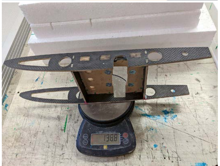
Konstruktion Einbau Hauptfahrwerk. Construction et montage du train d'atterrissage principal.
