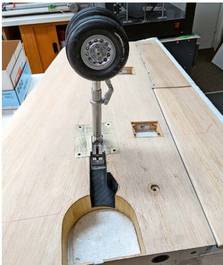
Fahrwerkeinbau mit Verkastung (3D-Druck). Montage du train dans son support (impression 3D).
