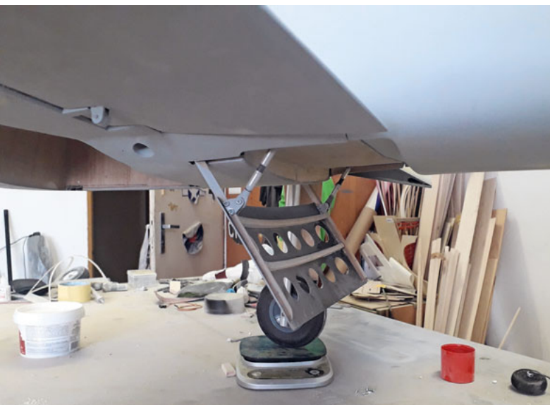
Aerodynamische Bremse, ausgefahren. Frein aérodynamique sorti.
