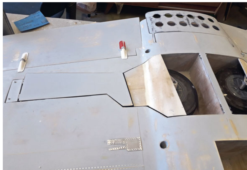
Aufwendige Fahrwerksklappen. Fermetures de train complexes.
