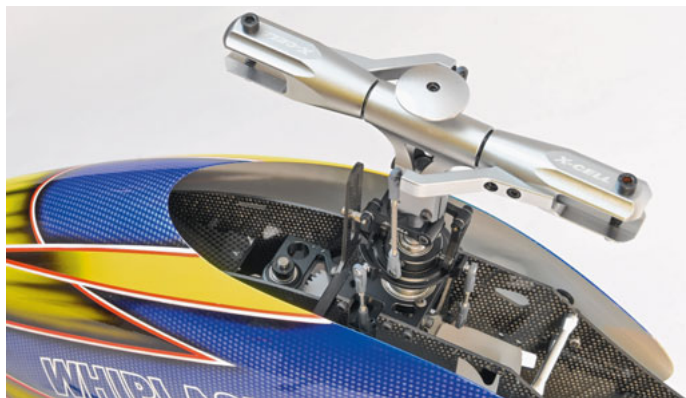
Vollaluminium-Rotorkopf mit 8mm Blattlagerwelle.
