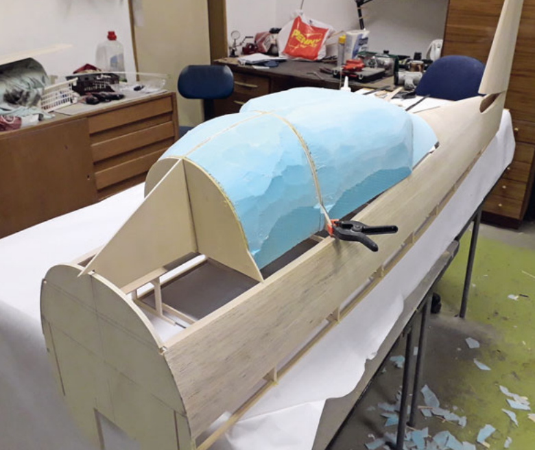
Kabinenhaube aus extrudiertem Polystyrol. Verrière en polystyrène expansé.
