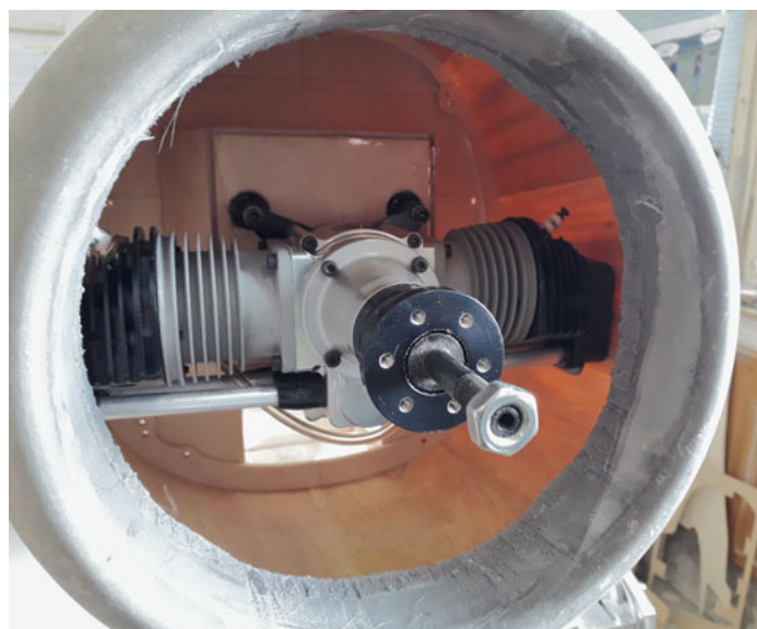
Ziemlich enge «Kiste», da bleibt nur wenig Platz für den Fiala 85B2. Fuselage assez étroit, ne laissant que peu de place pour le Fiala 85B2.
