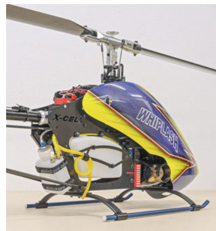
Hinten im Chassis ist der Haupttank (0,9 Liter) und der Hoppertank (0,125 Liter) montiert.
