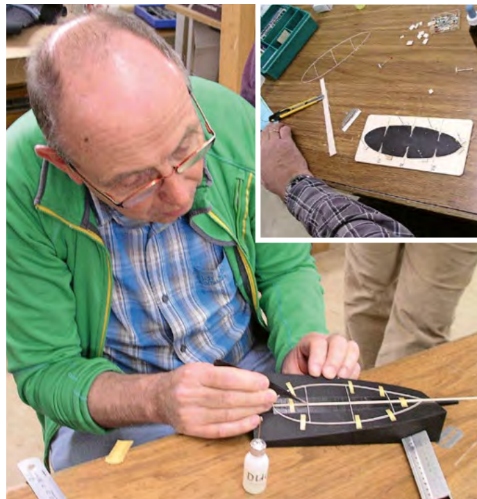
Bau eines Propellers für F1D mit der passenden Hilfslehre aus dem 3D-Drucker.
