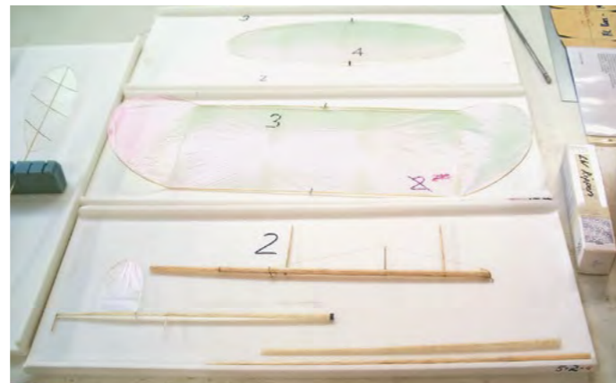
Detail Bauablauf – die Bestandteile des F1D-Modells, 1,4-Gramm-Fluggerät.
