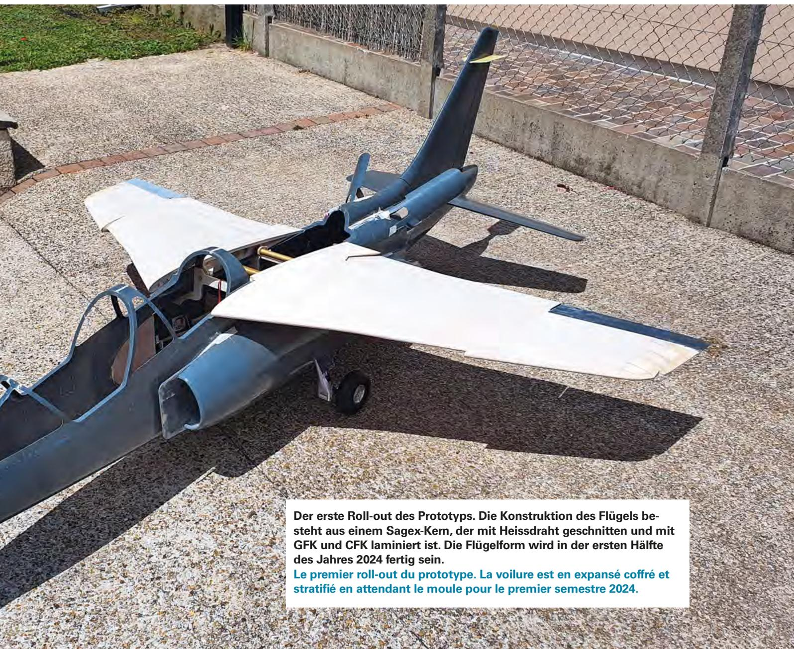
Der erste Roll-out des Prototyps. Die Konstruktion des Flügels besteht aus einem Sagex-Kern, der mit Heissdraht geschnitten und mit GFK und CFK laminiert ist. Die Flügelform wird in der ersten Hälfte des Jahres 2024 fertig sein.
