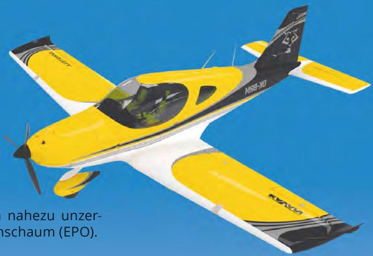
Ein komplett fertiggestelltes Semiscale-Modell aus dem nahezu unzerstörbaren, kohlefaserverstärkten, extrudierten Polyolefinschaum (EPO).
