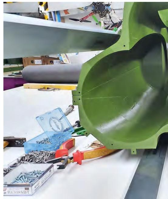
2 Rumpfhalschalen aus dem Drucker. Die Vorbereitungsarbeiten können beginnen. Durch Entformen sind die beiden Unterteile abnehmbar.
