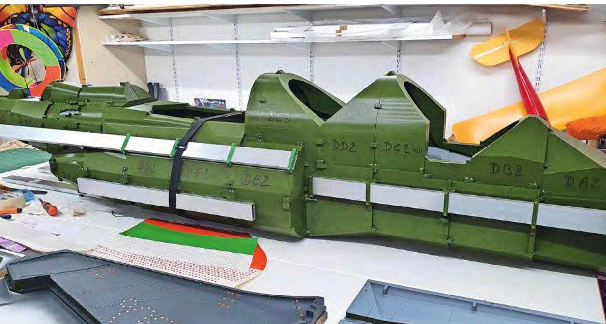
Die fertig gedruckte Rumpfform: Sie werden die zahlreichen zuvor zusammengesetzten Teilelemente bemerken. Die Metalllineale sorgen für eine allgemeine Ausrichtung.
