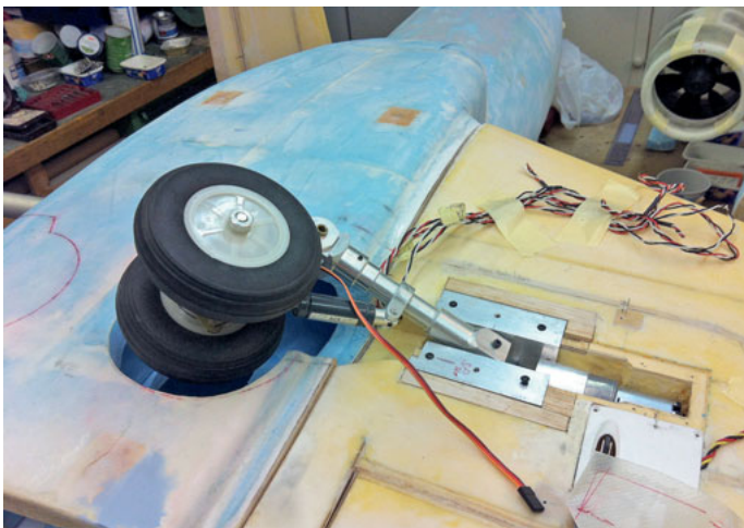
Einpassen des elektrischen Fahrwerks (Eigenkonstruktion) in den Rumpfschacht.
