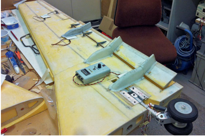
Fertig bearbeiteter Flügel mit Querruder, Landeklappen und Fahrwerkhalterung.
