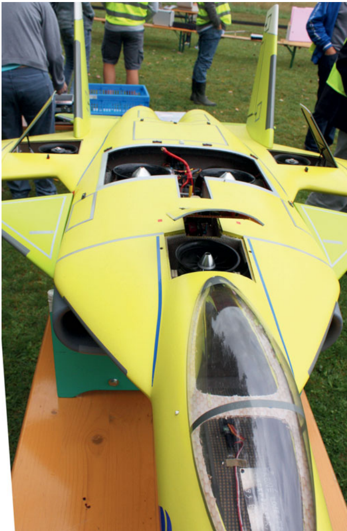
Schwenkbare Haupttriebwerke (in Flug durch Gitterblech verdeckt) ermöglichen vertikales Starten und Landen. Die unter Rumpflappen arbeitenden Hilfstriebwerke dienen hauptsächlich der Lagestabilisierung.
