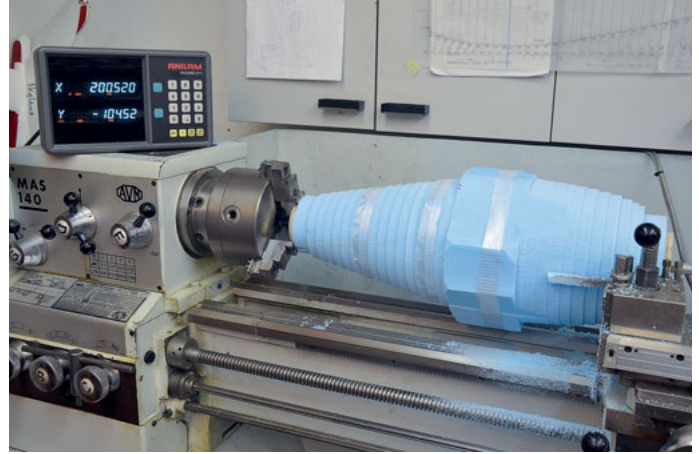
Herstellung der Gondel-Urform auf Drehbank entsprechend den Koordinatenpunkten nach Zeichnung.
