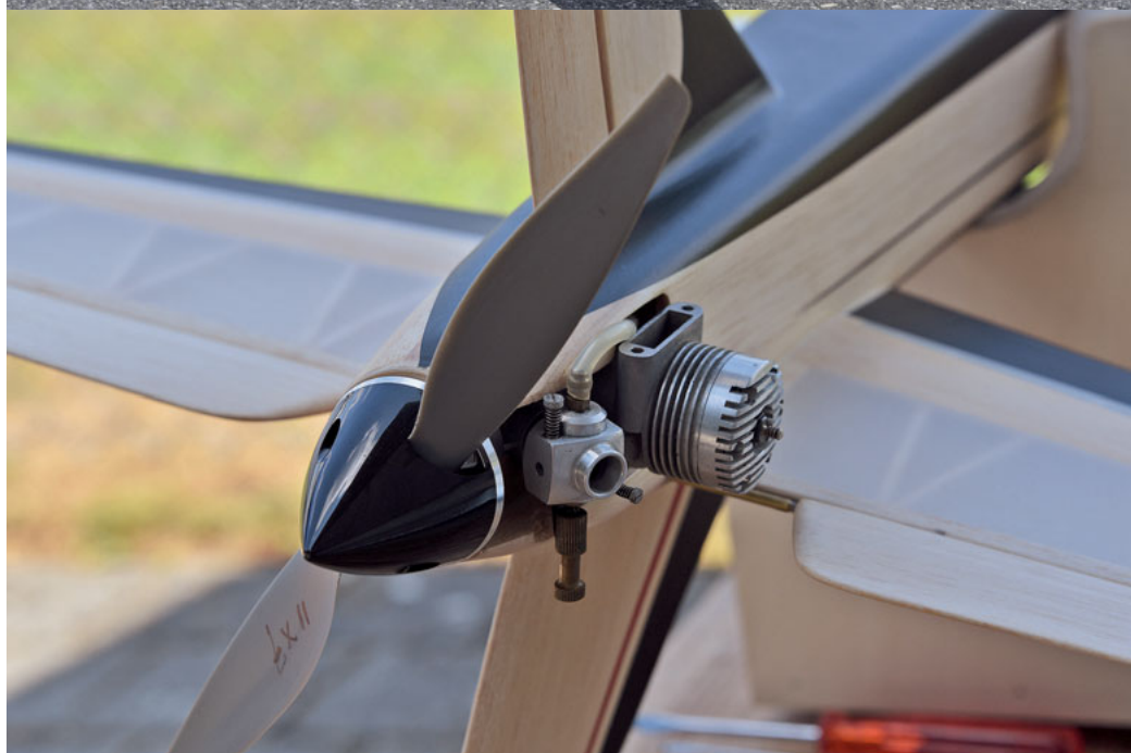
Gut gelungener Nachbau von Guido Patroncini. Motor-Attrappe mit elektrischem Innenleben.
