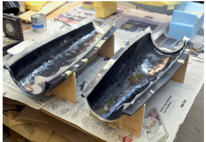
Fertige GFK-Glasfaser-Gondelhälften in Negativformen.
