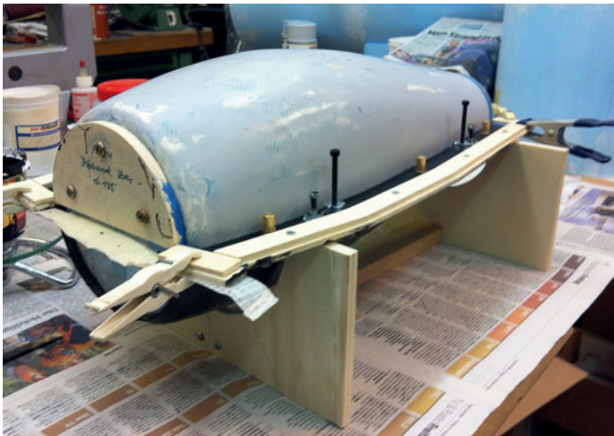
Giessen der zweiten Gondelhälfte auf vorbereitete erste Hälfte.
