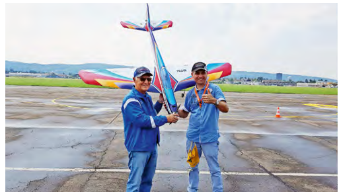
Modell: Opal II (Original WM von 1995). Konstruktion Wolfgang Matt. Gebaut von Nishioka/Japan. Motor: Yamada 140. Retract: Giezendanner EL-5. Futaba RC.
