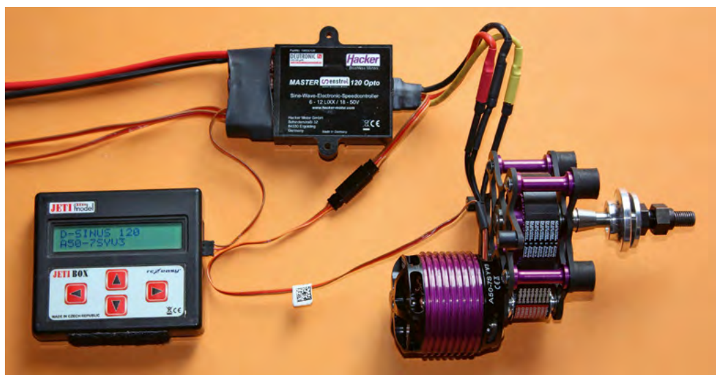
Das Einstellen der Parameter erfolgt mit der bekannten Jeti-Box.
