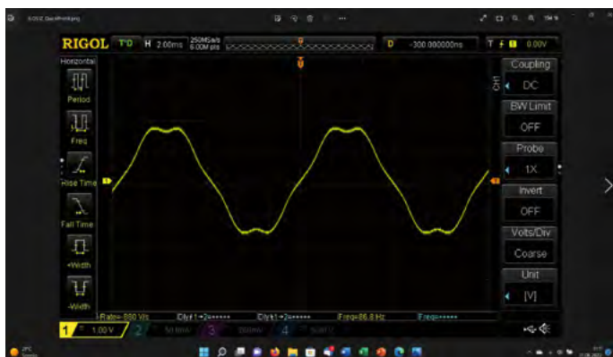
Sättigungerscheinungen im Magnetfeld eines Motors können aber auch zu einer verzerrten Sinusspannung führen (hier: Neu-Motor 1905-2.5 Y).
