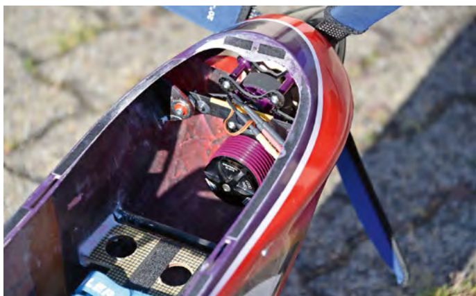
Der Einbau in den Rumpf erfolgt über schwingungsdämpfende Gummielemente.
