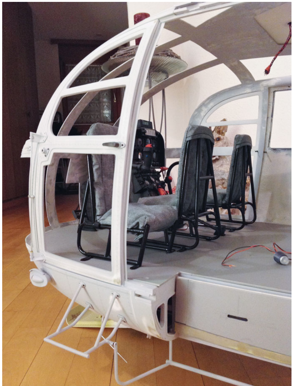
Der Ausschnitt im Boden für das Seil der Rettungswinde. Fehlen darf natürlich nicht ein funktionierender Bodendeckel.
