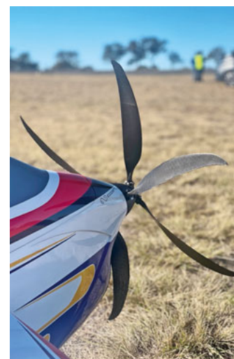
Adverrun-Antrieb mit AVR-Propeller in Sichelform.
