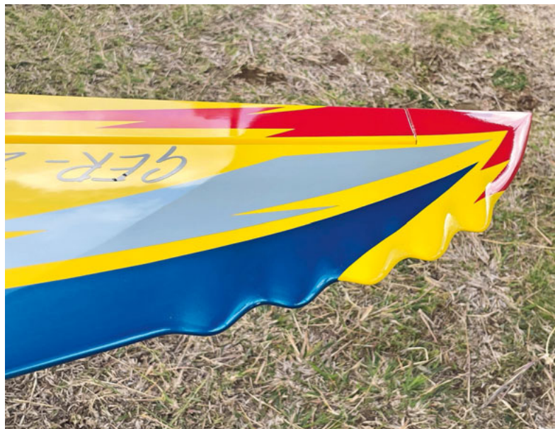
Randbogen am Modell Bionik von Robert Hirsch, GER. Bewusste Verwirbelung der Strömung im äusseren Flügelbereich.
