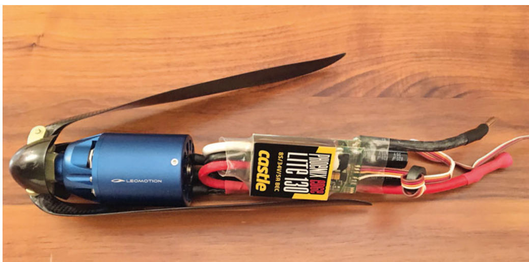
Regler platzsparend am Motor anlöten – 100-A-Antrieb mit 130-A-Regler.
