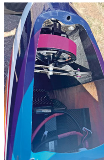
Flüsterantrieb Hacker Q80-11 PSD im Modell von Reto Schumacher.
