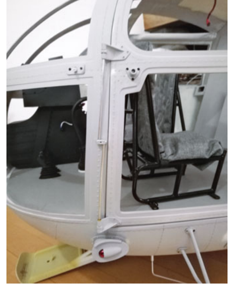
100% Scale, die Türscharniere der Vordertüren. Der Notabwurf funktioniert (noch) nicht.
