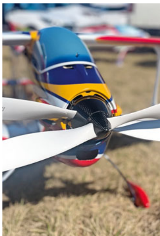
Contra-Antrieb von VLV. An der WM von 13 Piloten geflogen.
