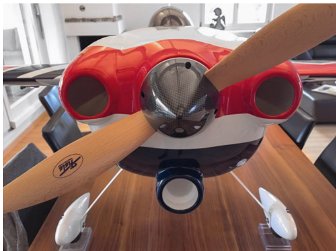
Beim Arbeiten am scharfem Antrieb ist der Propeller IMMER zu entfernen.
