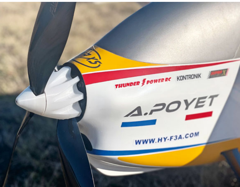
Kühlluftführung am Spinner von Arnaud Poyet, FRA.
