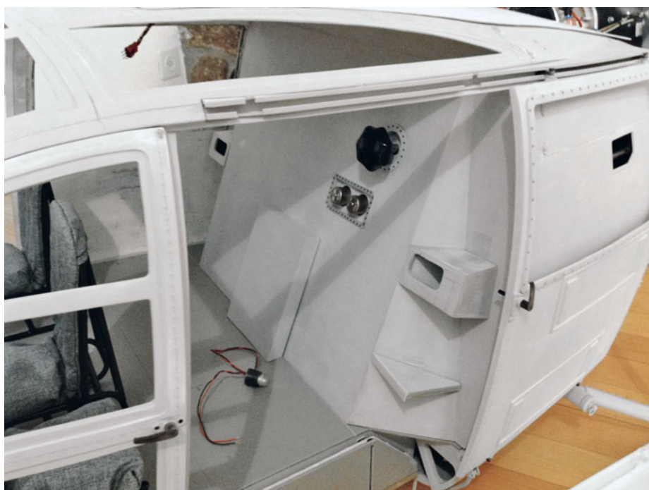
Schiebetüren wie beim Vorbild, auch auf dem Bild: die Rändelschraube für das abnehmbare Heck.
