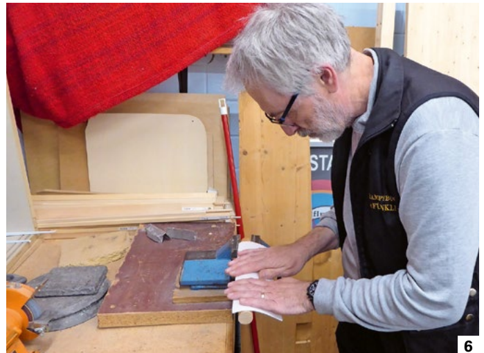
Tragfläche mit Rundholz biegen.
