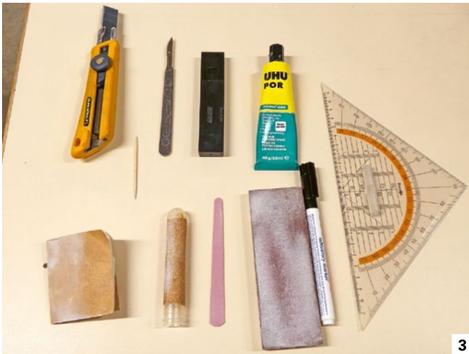
Werkzeug für Depron-Bearbeitung.
