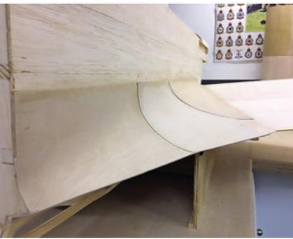
**Übergang Rumpf/Tragfläche.** Dieser Bereich ist mit 0,6-mm-Sperrholz realisiert. Die einzelnen Paneele sind so aufgebracht, dass durch die leichte Überlappung der originale Blechaufbau imitiert wird.
