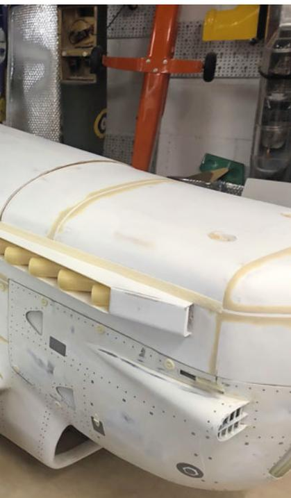
**Teilweise realisierter Oberflächen-Finish mittels Spachtel, Selbstklebefolie und selbst gegossenen Elementen. Insbesondere die typischen Scharnierelemente auf der Seite des Rumpfes sind hier zu erwähnen.**
