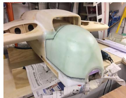
**Laminierte Motorabdeckung auf der Positiv-Form. Die späteren Stosskanten zum Rumpf sind bereits eingezeichnet.**
