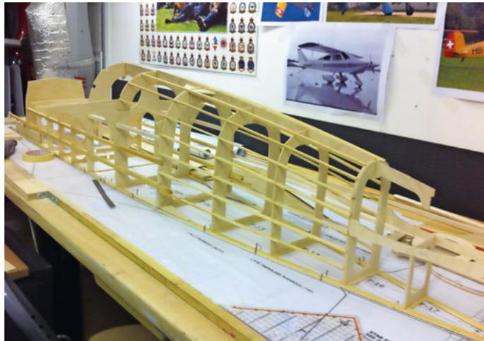
**Der Rumpf wird auf dem Rücken aufgebaut. Die Spanten sind aus Flugzeug- und Pappelsperholz ausgesägt. Die Längsträger bestehen aus Kieferleisten.**
