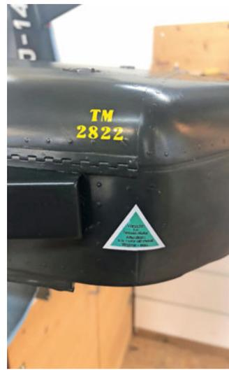
**Hinweisschilder und weitere Beschriftungen sind mit Wasser-Schiebetransfer-Bildern realisiert. Die Schrift «TM 2822» aufgrund der besseren Deckkraft mit Klebefolie.**
