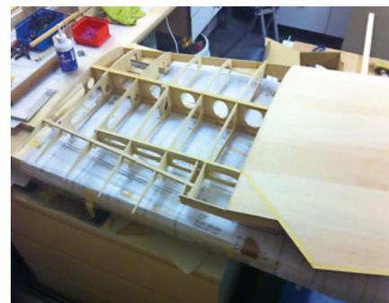
**Das Tragflächen-Mittelteil nimmt Gestalt an. Die Fahrwerksaufnahme ist bereits eingeklebt.**
