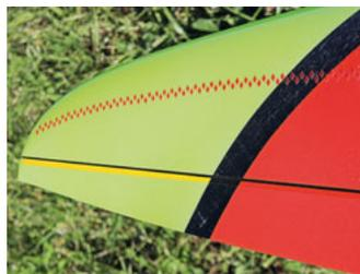
**Turbulateurs placés sur les ailes et le stabilisateur à l'extrados et l'intrados.**
