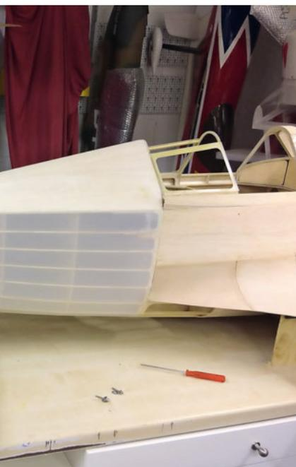
**Bespanntes Heck. Am Heck und insbesondere am Leitwerk habe ich versucht, so leicht wie möglich zu bauen. Die kurze Nase des Modells stellt ein grosses Problem bezüglich Schwerpunkt dar! Deshalb sind die Steuerflächen auch bespannt.**
