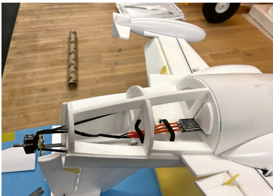
Der Regler war hier kühltechnisch nicht ganz optimal platziert. Pour un refroidissement optimal, le régulateur n'était pas placé de manière idéale.
